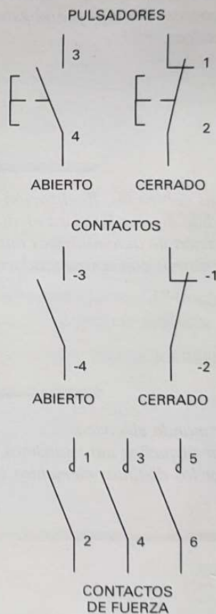
Figura 3.3. Numeración de los contactos.
